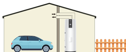
Installazione con 2 condotti in una stanza non riscaldata >15m²
